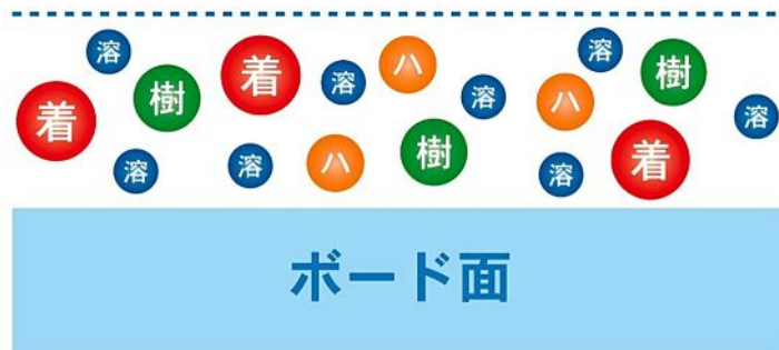
図3 ハクリ剤だけがボード面に残る
